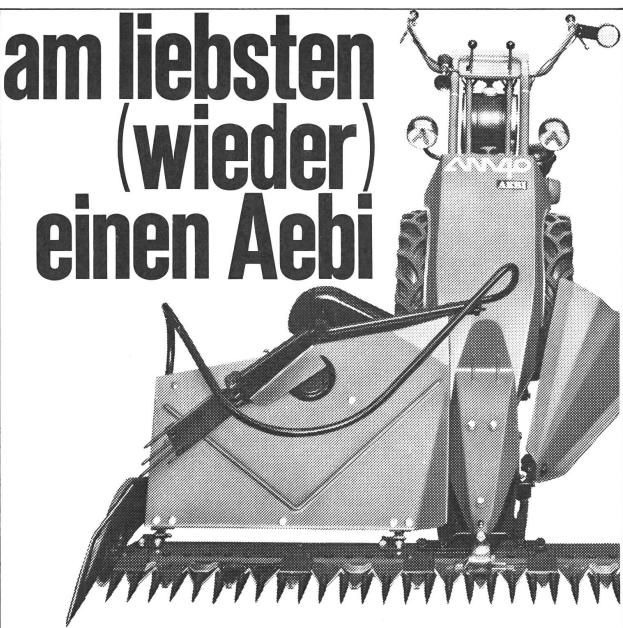
wegen dem frei schwingend aufgehängten Mähapparat mit dem Keilriemenantrieb (Schutz für Klingen und Finger), wegen dem sauberen Schnitt, dem praktischen Messerkopf und dem handlichen Mahdenformer, den man in 3 Handgriffen – ohne Werkzeug! – wegnehmen und wieder aufstecken kann. Gründe genug, zuerst an einen Aebi zu denken.
