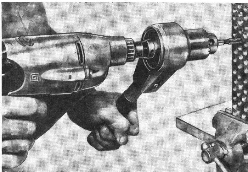
winde. Darüber hinaus kann man mit dem Vorsatzgetriebe auch Schrauben ein- und ausdrehen. Es ist ein vielseitiges Gerät, das in keiner Hofwerkstatt fehlen dürfte. -nbr-
