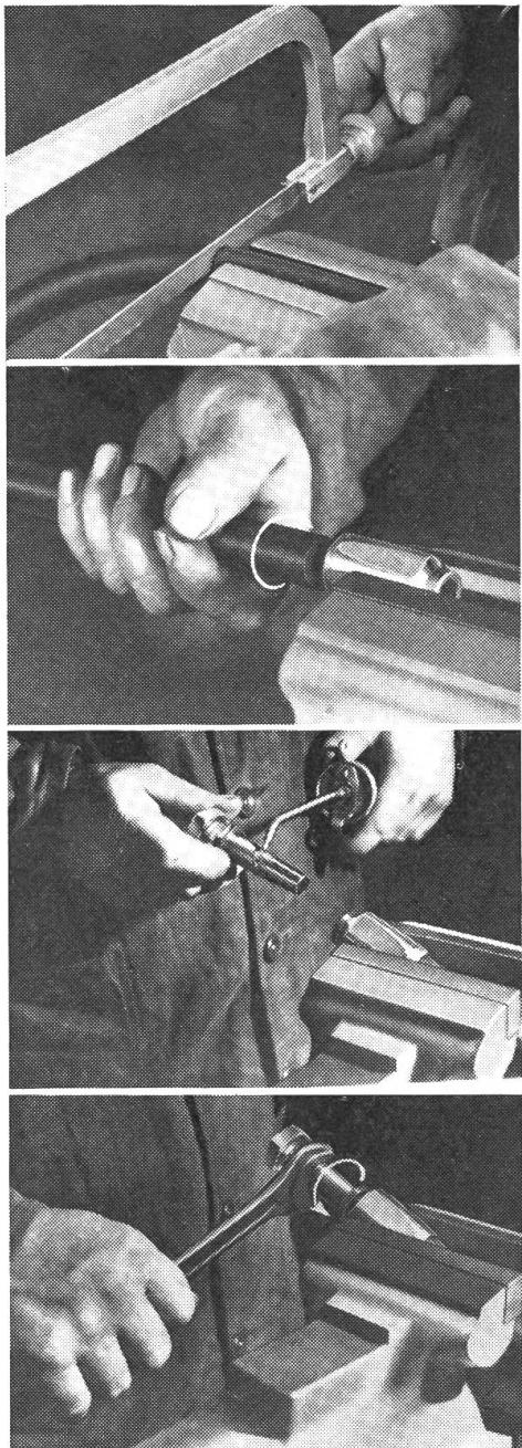
An einer Anzahl von selbstfahrenden Maschinen wie Traktor, Mähdrescher, Vollerntemaschinen usw. ist die Hydraulik nicht mehr wegzudenken. Sie kann aber nur intakt sein, wenn auch die Hydraulikschläuche den harten Arbeitsbedingungen standhalten. Wenn einmal ein derartiger Schlauch aufreißt, kann die Weiterarbeit in Frage gestellt sein, wenn nicht der Reparateur den entsprechenden Hydraulikschlauch am Lager hat.
