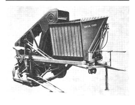
Erwähnenswert wäre noch in diesem Zusammenhang, dass der im Boden des Hochförderers angehakte Rost das Reinigen der Rüben vom Schmutz besorgt.
