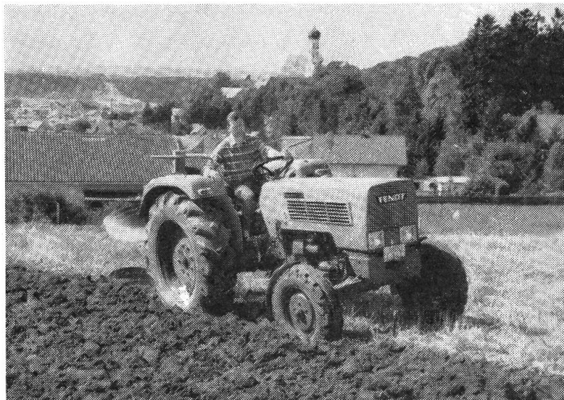
Traktor Fendt-Farmer 2 S, 42 DIN-PS (47 SAE-PS) mit 3-scharigem Volldrehflug
