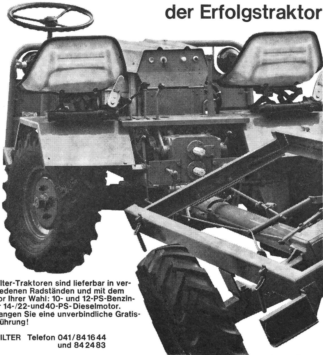
Schilter-Traktoren sind lieferbar in verschiedenen Radständen und mit dem Motor Ihrer Wahl: 10- und 12-PS-Benzin- oder 14-/22- und 40-PS-Dieselmotor. Verlangen Sie eine unverbindliche Gratis-Vorführung!
