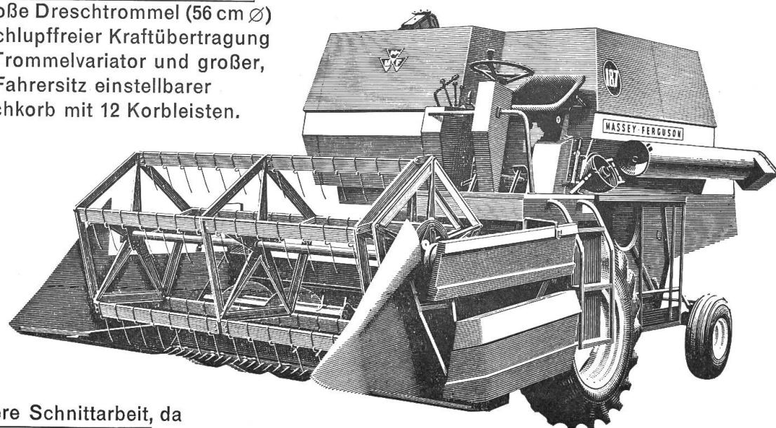
Saubere Schnittarbeit, da schwimmende Schneidwerkführung.
