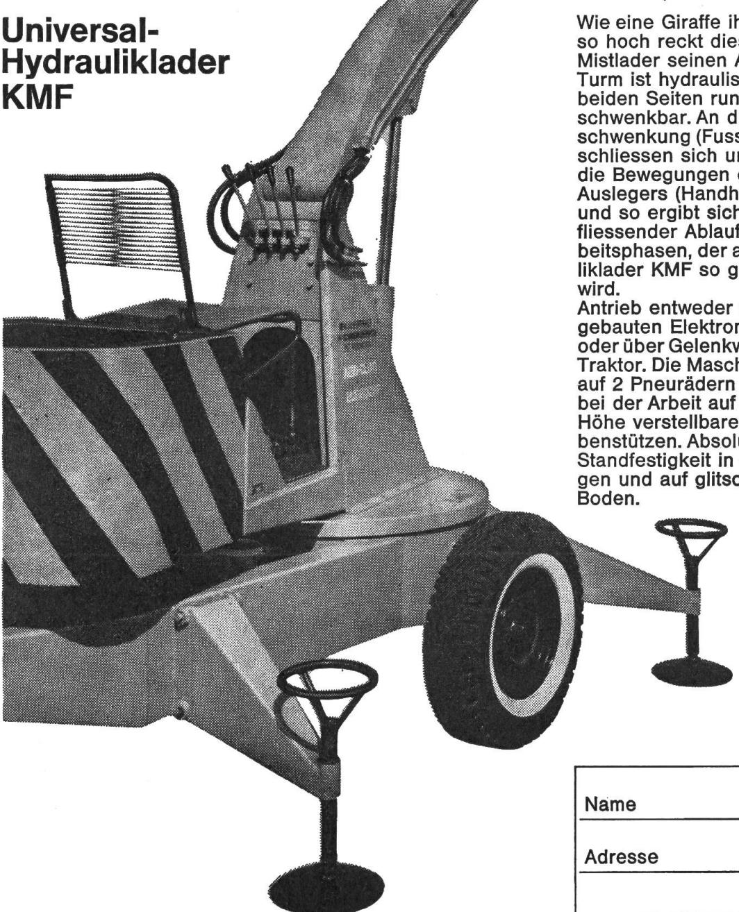
Wie eine Giraffe ihren Hals, so hoch reckt dieser Mistlader seinen Arm. Der Turm ist hydraulisch nach beiden Seiten rundum schwenkbar. An die Turmschwenkung (Fusspedal) schliessen sich unmittelbar die Bewegungen des Auslegers (Handhebel) an, und so ergibt sich ein fliessender Ablauf der Arbeitsphasen, der am Hydrauliklader KMF so geschätzt wird.
