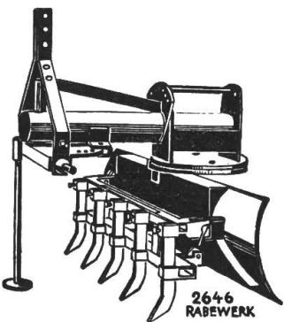
Planiergerät für den Strassenunterhalt und Planierarbeiten 183 oder 213 cm ab Fr. 1690.— auf Wunsch mit Stützrad.
