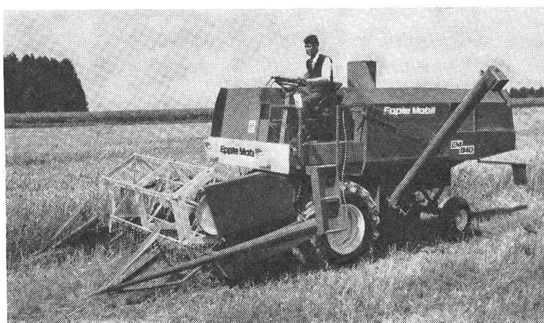
Abb. 1: Mähdrescher-Selbstfahrer EM 840 der Epple-Buxbaum-Werke, Wels/Oesterreich
