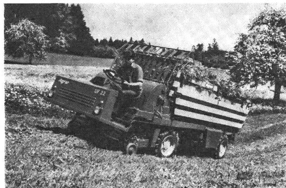
Die Abbildung zeigt das neue Agrar-Universalfahrzeug als selbstfahrenden Ladewagen im Einsatz. Dank dem 4-Rad-Antrieb und der hydraulischen 4-Rad-Lenkung ist es ausserordentlich wendig und erlaubt das Befahren von Hanglagen, in denen bis heute ein Maschineneinsatz unmöglich war.
