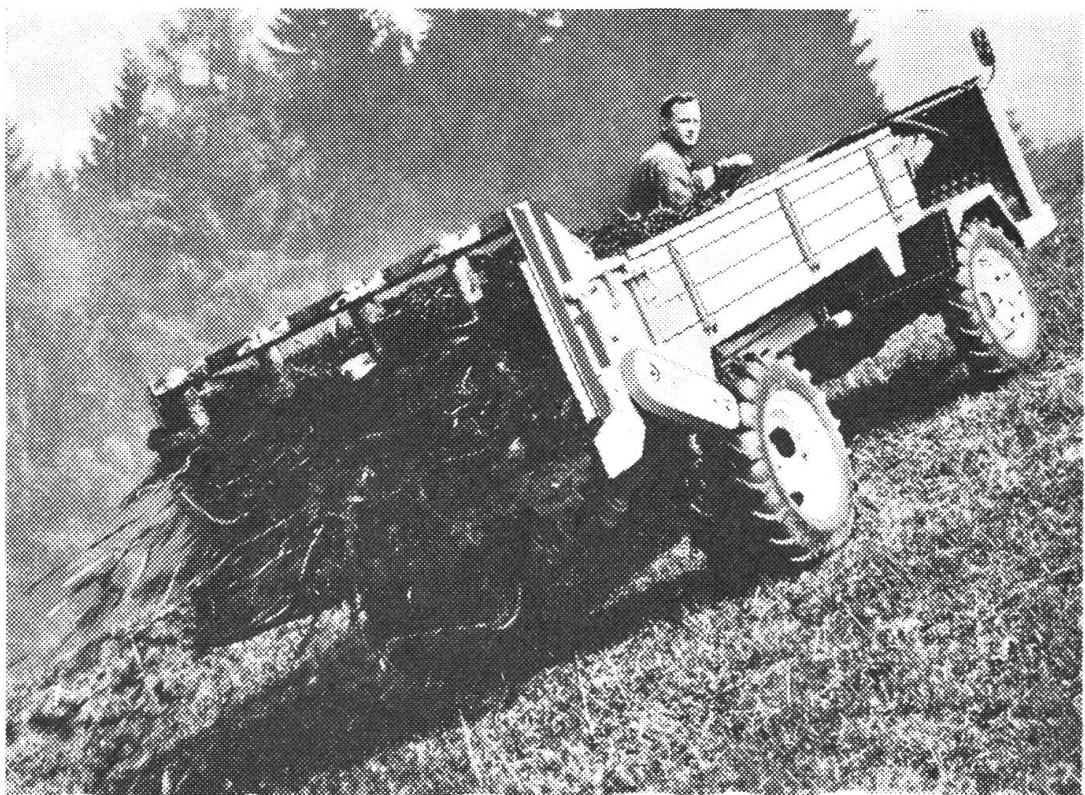
Der REFORM MULI 25 als Transporter, Ladewagen und Mistzetter, ergänzt mit Güllefaß, Kreiselheuer, Seilwinde, Schneepflug u. a. m., setzt neue Maßstäbe zur rationelleren Bewirtschaftung bergbäuerlicher Betriebe. Die bewährten, technischen Details: kraftvoller, luftgekühlter Dieselmotor von 25 DIN-PS, Allradantrieb, Differentialsperre hinten, Portalachsen, Achsschenkellenkung, 8 Vor- und Rückwärtsgänge und Zwillingspneus hinten.
