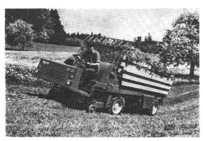
Die Abbildung zeigt das neue Agrar-Universalfahrzeug als selbstfahrenden Ladewagen im Einsatz. Dank dem 4-Rad-Antrieb und der hydraulischen 4-Rad-Lenkung ist es ausserordentlich wendig und erlaubt das Befahren von Hanglagen, in denen bis heute ein Maschineneinsatz unmöglich war.
