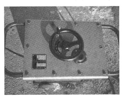
Mittels des Handrades kann der Schweißstrom von 20—180 Amp. stufenlos verstellt werden.
