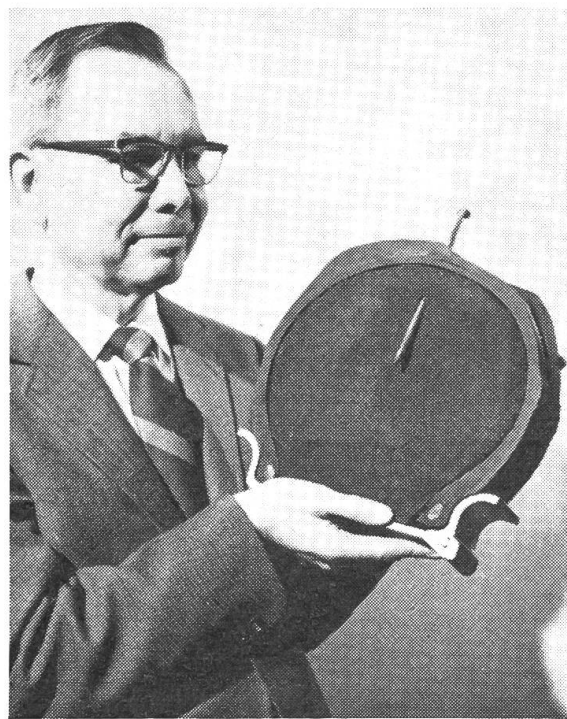
Querschnittaufnahme vom Goodyear-Schaumstoffreifen.
