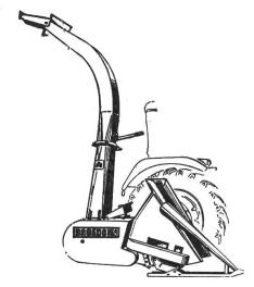
Im Eiltempo verwandelt der HAGEDORN-Maishäcksler HM 69 einen ausgewachsenen Maiswald in nahrhaftes Kraftfutter. Sauber gekappt, exakt auf 6 mm Schnittlänge gehäckselt, präzise auf den angehängten Wagen geblasen. In züglgem, störungs- und verstopfungsfreiem Fluss verarbeitet die Maschine Stengel, Blätter, Kolben. Nichts geht verloren.
