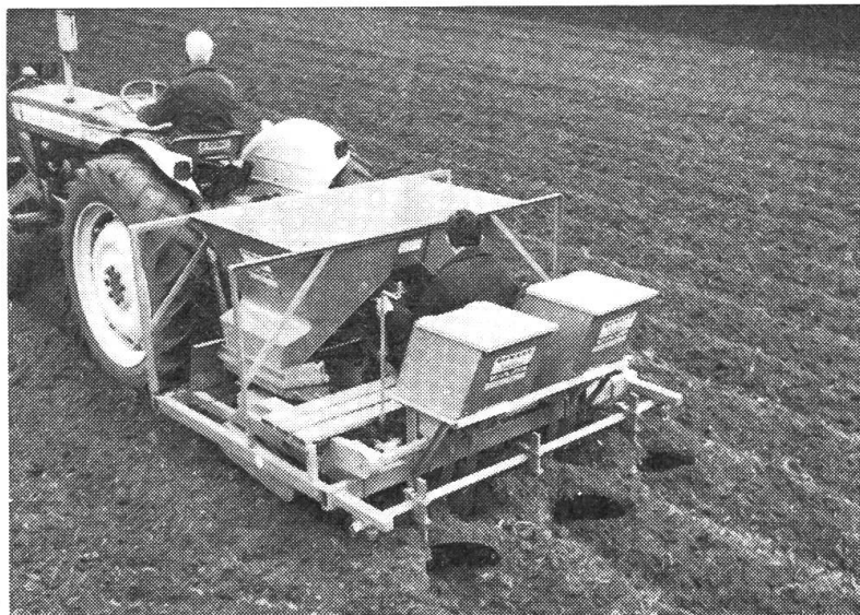
Abb. 3: «Howard» Hochleistungs- Kartoffellegemaschine für vorgekeimtes Pflanzgut mit Reihen- düngerstreuer.
