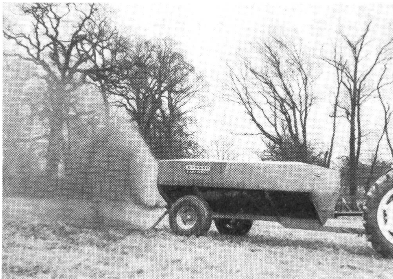
Abb. 2: «Howard» Schleuderwagen für Kot aus Laufställen.
