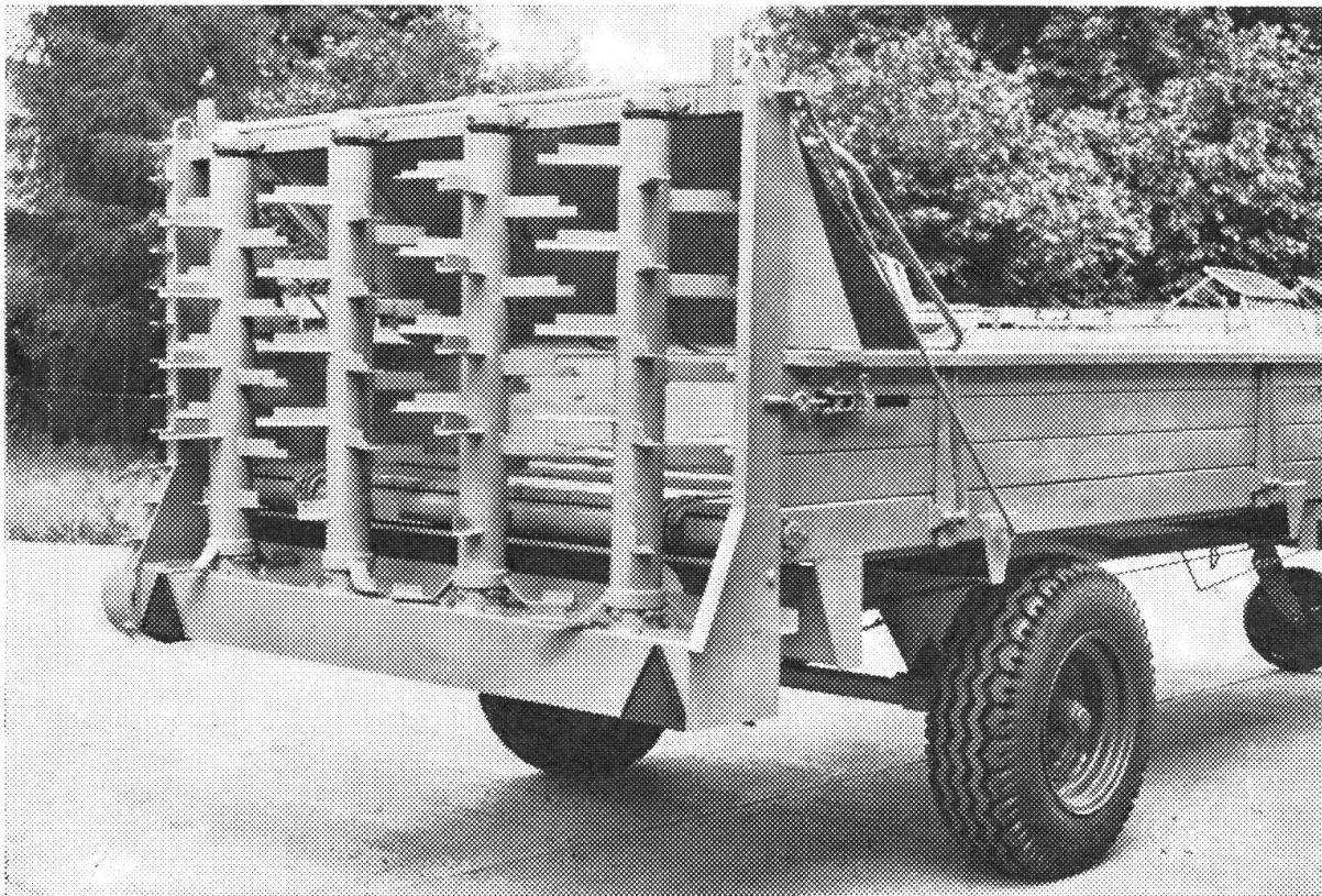
Das neue 4-Walzen-Streuwerk ist ein AGRAR-Fabrikat. Mühelos und ohne Werkzeug ist es von der Maschine abnehmbar. Die 4 Ölbad-Getriebe und einsatzgehärtete Zinken vermindern die Abnützung stark.
