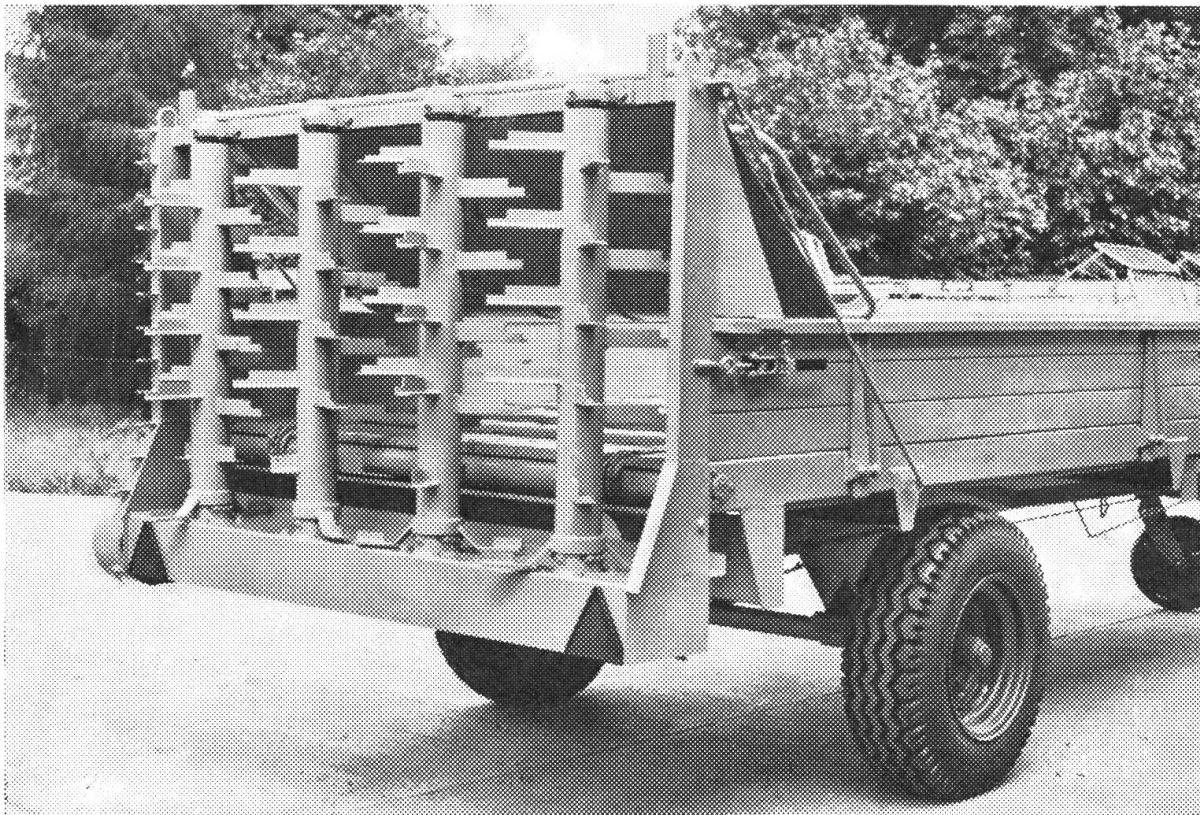
Das neue 4-Walzen-Streuwerk ist ein AGRAR-Fabrikat. Mühelos und ohne Werkzeug ist es von der Maschine abnehmbar. Die 4 Ölbad-Getriebe und einsatzgehärtete Zinken vermindern die Abnutzung stark.
