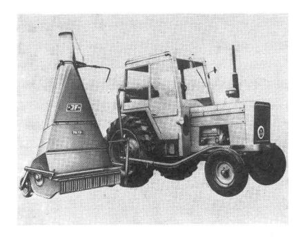
Abb. 3: Der neue, schwere -JF-Schlegel-Feldhäcksler für Seitenanbau.
