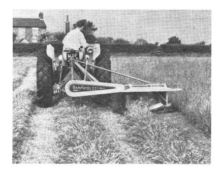
dacht. Schnittbreite 2,00 m. Bamfords bauen aber auch schon seit Jahren Fingerbalken-Mähwerke und zeigten hier ein neues Heckanbau-Mähwerk mit einem besonders langen Messerhub, der sich über drei Finger erstreckt.
