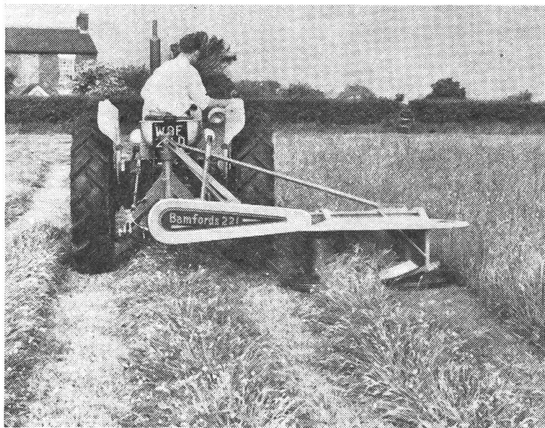
Abb. 1: «Bamfrod-Wizzler», ein neuer Kreiselmäher mit Obenantrieb.
