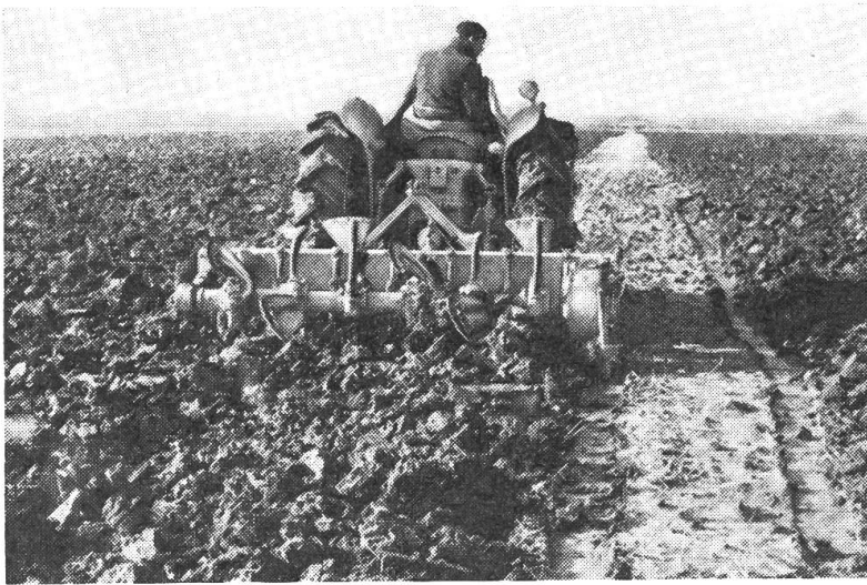
Abb. 5: Dieses Gerät bearbeitet eine Breite von 2,1 m. Für den Ackerbau ist ein Durchbruch dieses Gerätes auf Grund der geringen Arbeitsgeschwindigkeit zunächst nicht zu erwarten.
