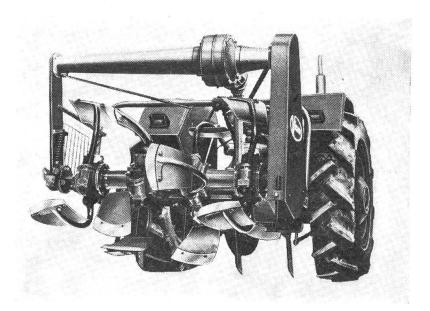
Die einzelnen Spaten stechen nach vorne senkrecht in den Boden ein, brechen ein Stück aus und heben es nach hinten an. In diesem Moment wir der Spaten durch eine in der Hohlwelle liegende Gleitbahn seitlich um 90° gedreht, so dass der Boden vom Spatenblatt hochkant in das durch den Aushub entstandene Loch fällt. Der Spaten dreht sich dann wieder in die Ausgangsstellung zurück, so dass er erneut einstechen kann. Die Arbeitstiefe wird mit 35 cm angegeben.
