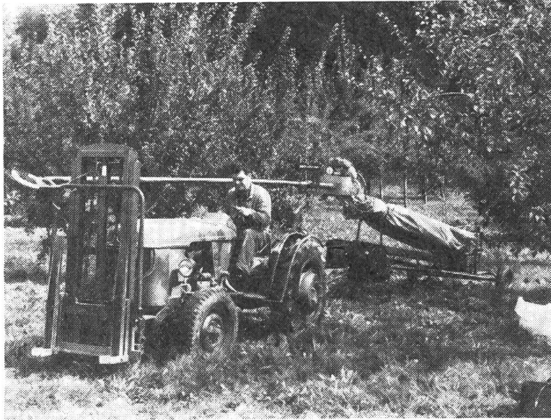
Obsterntegerät (Hydrl. Baumschüttler) mit Auf- fangrahmen zusammen- geklappt und Transport- rinne angebaut am Traktor mit Hubstapler zum Einsatzort fahrend.
