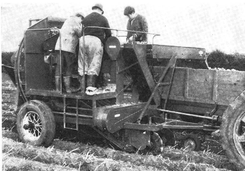
Bei F. P. Standen & Sons, Ely, wurde die selbstfahrende Rübenerntemaschine viel beachtet. Die einreihig arbeitende Maschine kann von einem Mann allein bedient werden. Ein Ueberladebunker sammelt die Rüben. Motorausrüstung verschiedener Fabrikate nach Wahl. Der Tank hat ein Fassungsvermögen von 1,5 l.
