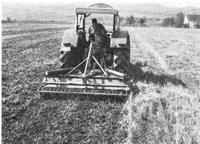
Abb. 1: Stoppelumbruch und Einmulchen von Mähdrescher-Langstroh mit einer Fräse, die zur exakten Tiefenregulierung mit einer Tragwalze ausgerüstet ist. Diese Tragwalze presst auch die obenauf liegenden Strohteile in den Boden.
