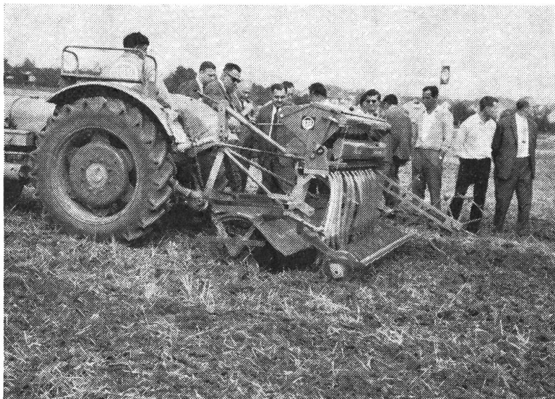
Abb. 2: Stoppelumbruch und Zwischenfruchtsaat mit einer Fräs-Drill- Kombination. Die grosse Tragfähigkeit der hier verwendeten Tragwalze garantiert auch bei dieser grossen Belastung eine gleichmässige Arbeits- tiefe. (Rau-Kombi-Werkbild)
