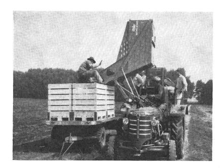
Abb. 2: Beim Einsatz der Paloxen mit Bunker-Vollernter erfolgt das Umladen der Kartoffeln am Feldrande.
