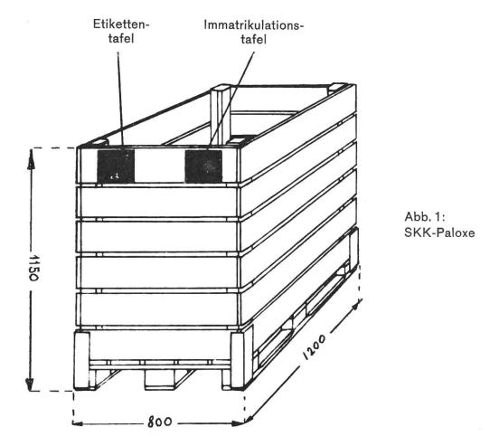
Ueber die Einsatzmöglichkeiten der Paloxen für die Kartoffelernte und -lagerung wurden in den Jahren 1967/68 eingehende Untersuchungen durchgeführt. Dabei ging es vor allem um die Abklärung der arbeitstechnischen Probleme und der Arbeitsqualität unter besonderer Berücksichtigung der Knollenbeschädigungen sowie der Wirtschaftlichkeit. Folgende Arbeits-verfahren wurden dabei untersucht:
