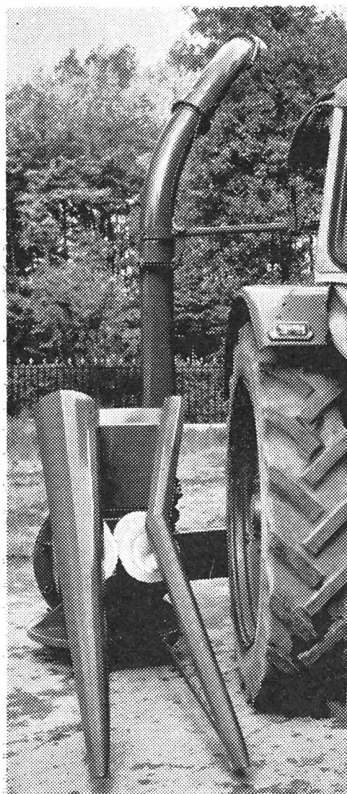
Diese Maschine arbeitet weder mit Einzugsketten, noch hat sie eine Messertrommel. Als Schneidwerkzeug dient eine Schneidscheibe, ähnlich wie beim Rübenschneider. Durch die Blattheber werden die Maisstengel dem Schneckeneinzug zugeführt, wobei sie durch Mähmesser am Außenrand der Schneidscheibe gemäht und dann, aufrecht stehend, von oben nach unten durch die Schneidscheibe gestossen und von den Häckselmessern geschnitten werden. Die Häcksellänge ist stufenlos von 7 bis 18 mm einstellbar.
