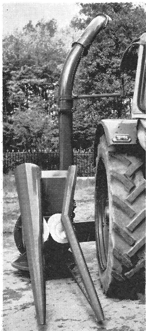
Diese Maschine arbeitet weder mit Einzugsketten, noch hat sie eine Messertrommel. Als Schneidwerkzeug dient eine Schneidscheibe, ähnlich wie beim Rübenschneider. Durch die Blattheber werden die Maisstengel dem Schneckeneinzug zugeführt, wobei sie durch Mähmesser am Außenrand der Schneidscheibe gemäht und dann, aufrecht stehend, von oben nach unten durch die Schneidscheibe gestossen und von den Häckselmessern geschnitten werden. Die Häcksellänge ist stufenlos von 7 bis 18 mm einstellbar.
