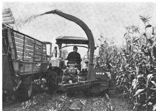
1. Erzielung eines exakten Kurzschnittes von 5 mm, der das Aufschliessen jedes einzelnen Maiskornes garantiert. Das bewährte Scheibenradprinzip in Verbindung mit exakter Vorpressung direkt am Schneidmund
