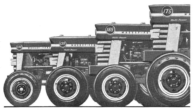
**MF 130** 35 DIN/40 SAE PS **MF 135** 46 DIN/53 SAE PS **MF 165** 65 DIN/74 SAE PS
