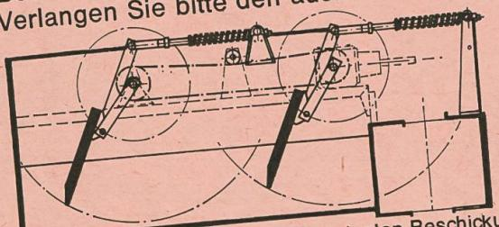
Patentiertes AMA-System zur konstanten Beschickung des Presskanals.
