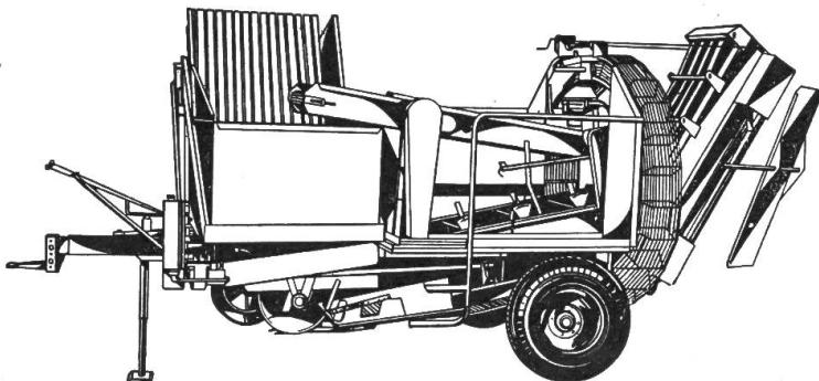
Der **Typ-RL** mit Ladefläche von 3,2 m<sup>2</sup> findet bevorzugt Verwendung in Frühkartoffel-Anbaugebieten. Am Auslaufende des Verlesebandes ist ein Absackkasten mit 2 Sackhalterungen angebracht.
