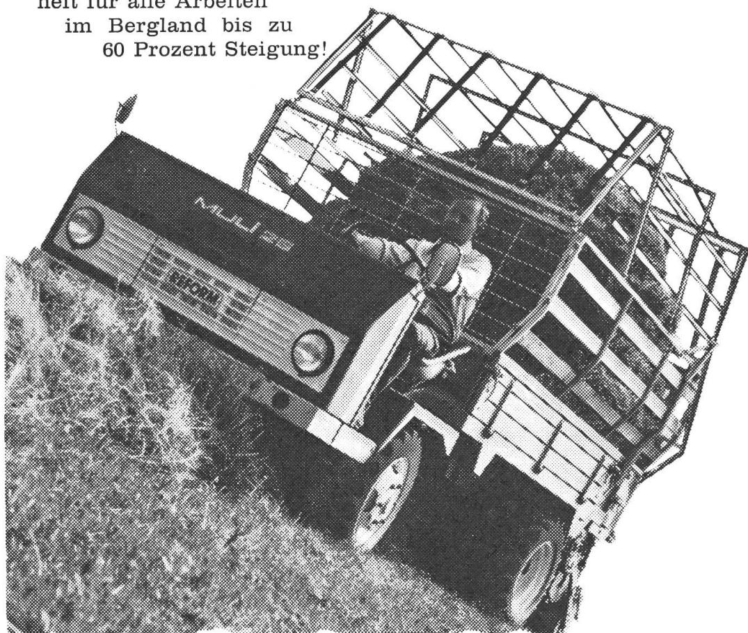
Der REFORM MULI 25 als Transporter, Ladewagen und Mistzetter, ergänzt mit Güllefaß, Kreiselheuer, Seilwinde, Schneepflug u. a. m., setzt neue Maßstäbe zur rationelleren Bewirtschaftung bergbäuerlicher Betriebe. Die bewährten, technischen Details: kraftvoller, luftgekühlter Dieselmotor von 25 DIN-PS, Allradantrieb, Differentialsperre hinten, Portalachsen, Achsschenkellenkung, 8 Vor- und Rückwärtsgänge und Zwillingspneus hinten.
