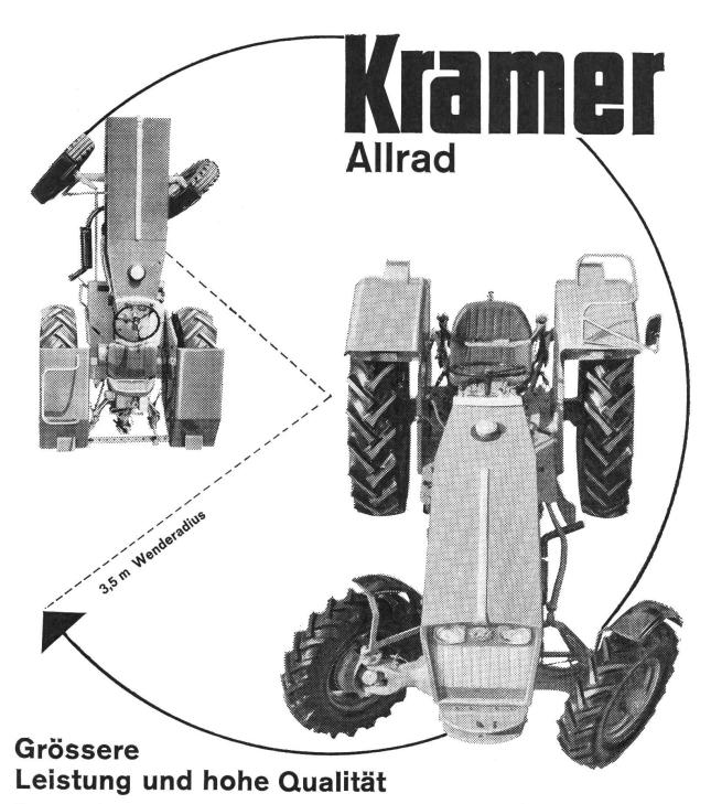
Der neue Kramer-Allrad kann die Zugkraft bis um 30% steigern. Der sehr grosse Lenkeinschlag von 60° bringt äusserste Wendigkeit bei knappstem Raum. Verblüffend einfach ist das Synchron-Lastschalt-Wendegetriebe zu bedienen. Einzigartig gelöst ist die oelhydraulische Vierradbremse und Einzelradbremse mit Vorwählung, ein wichtiger Faktor zur Unfallbekämpfung. Im Kramer-Traktor findet der Praktiker seine Wünsche erfüllt.
