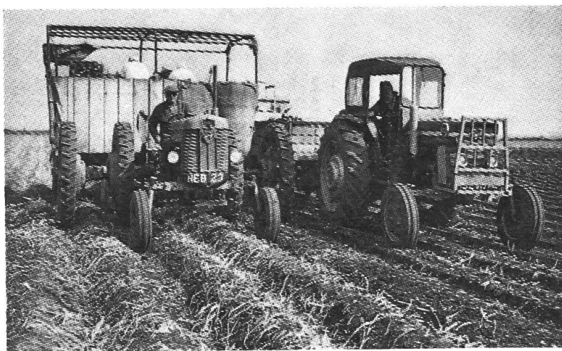
Abb. 1: Neuartige Zwillings- bereifung von «Avon» mit Abstandbüchsen, damit die Räder in den Furchen laufen.
