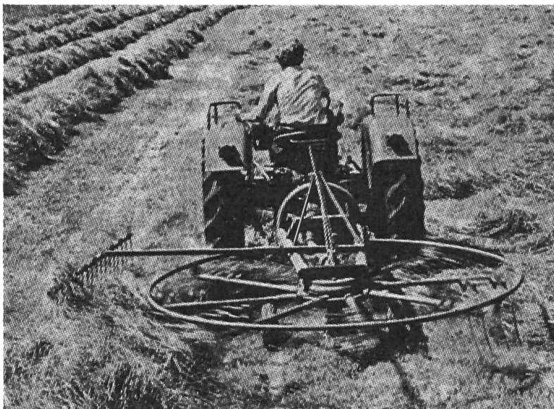
Abb. 11: Der Kreiselschwader «Kuhn» soll sich dank der geführten Rechengabel zum Rechen sehr gut eignen.
