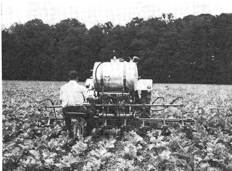
Abb. 1: Günstiger Anbau einer serienmässigen Dreipunkthackmaschine am Frontlader. Der Abstand vom Hackschar zum Vorderrad ist so kurz wie möglich.
