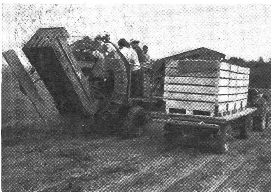
Abb. 2 und 3: Das Verfahren mit Elevator-Vollernter ermöglicht ein direktes Beladen der Paloxen, erfordert jedoch zwei Traktoren (Abb. 2), mit Bunker-Vollernter werden die Paloxen am Feldrande beladen (Abb. 3).
