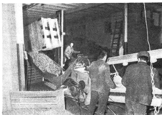
Abb. 8, 9, 10, 11: Beim Paloxeneinsatz lassen sich alle Umschlagsarbeiten rasch und schonend durchführen (Abb. 8, 9). Zum Entleeren werden die Paloxen entweder mit dem Hubstapler (Abb. 10) oder mit einem Spezialgerät gekippt (Abb. 11).
