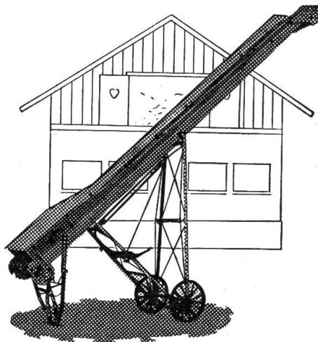
Der Rahmen ist aus speziellen, kaltgeformten Stahlelementen hergestellt. Der Boden (68 cm breit) und die Seitenwände sind aus verzinktem Blech. Der Rücklauf der Klammer ist geschützt, um das Auflegen auf Fenster, Balken und Silos usw. zu ermöglichen. Das Fahrgestell ist mit einem Flaschenzug versehen, um das Heben zu erleichtern. Es kann zudem nach hinten verschoben werden, was ein tieferes Eindringen in Gebäude gewährleistet.
