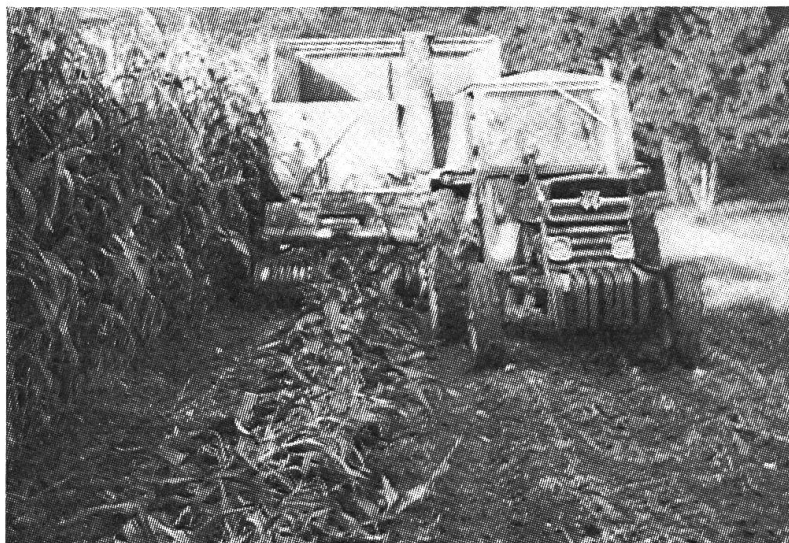
Abb. 1: Häckselladewagen beim Aufnehmen von Silomais.
