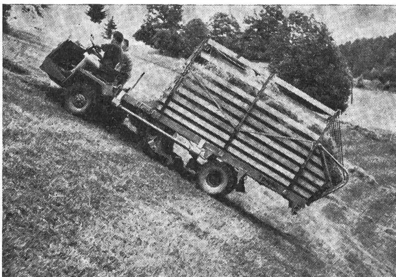
Abb. 6: Dieser Selbstfahr-Ladewagen ist beinahe ein «Allesfresser» und trotz der kleinen Räder ein sehr guter «Kletterer».
