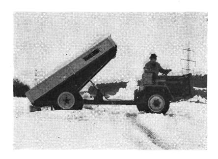
Eine hydraulische Kippvorrichtung wurde nur zu einem Transporter beigestellt, die sich im praktischen Betrieb gut bewährt hat. Es ist eigentlich unverständlich, warum sich nicht alle Transporter-Hersteller damit befassen, wenigstens eine mechanische Kippvorrichtung für die serienmässige Ladepritsche zu bauen.
