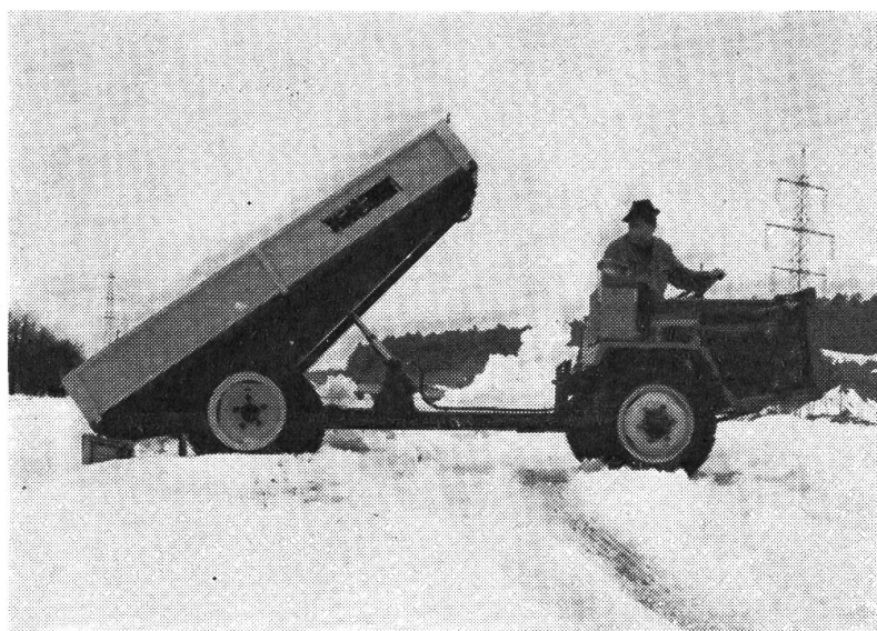
Abb. 7: Die hydraulische Kipp- vorrichtung hat sich im praktischen Betrieb aus- gezeichnet bewährt.
