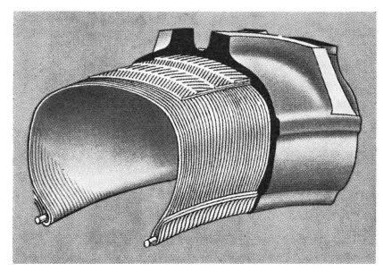
Abb. 3: Bei dieser schematischen Darstellung ist der Aufbau des Gürtel- oder Radialreifens gut ersichtlich (radiale Karkasse und «Gürtel» oder Laufband).
