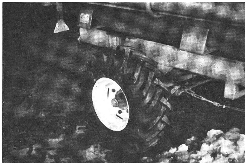
Abb. 5: Das AS Profil ist dort am Platze, wo Hanglagen befahren werden müssen und man auf eine gute Bremswirkung angewiesen ist.
