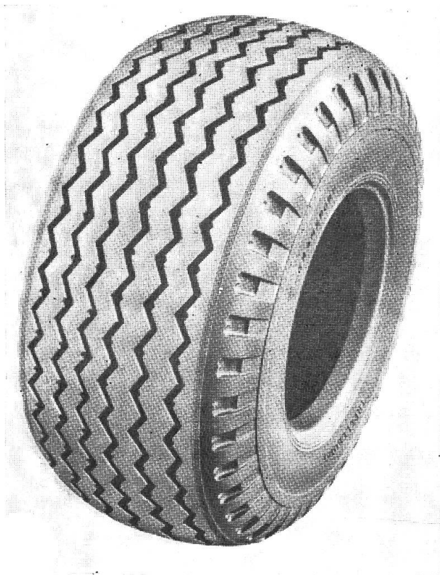
Abb. 4: Solche Niederquerschnittreifen haben sich in der Praxis gut bewährt. Die Auflagefläche ist gross, was bei grossen Achslasten besonders wichtig ist.
