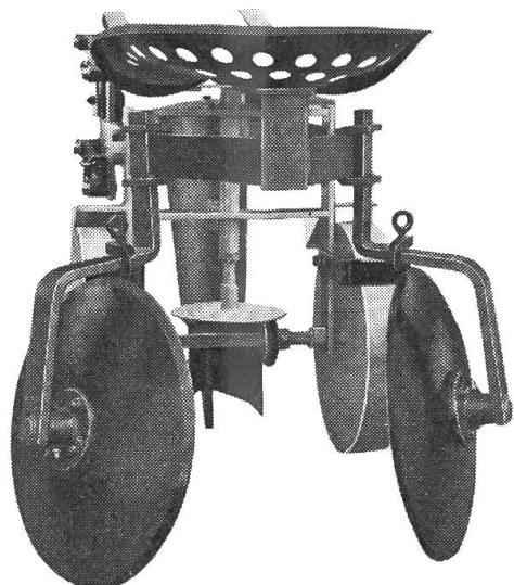
Reihen enger oder weiter setzen, wobei wir Rücksicht zu nehmen haben auf Sorte, Knollengrösse, Bodenart und Reihenabstand. Diesem Bedürfnis entspricht der neue Kartoffelsetzapparat am Aebi-Vielfachgerät: die Pflanzdistanz lässt sich hier an einer einzigen Schraube stufenlos von 25 bis 45 cm verstetzen. Auch sonst weist der Aebi-Setzapparat heute praktische Neuerungen auf, die zu kennen es sich lohnt.
