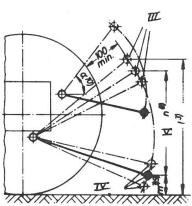
Anlenkpunkte am Traktor und Kupplungspunkte für das Gerät
