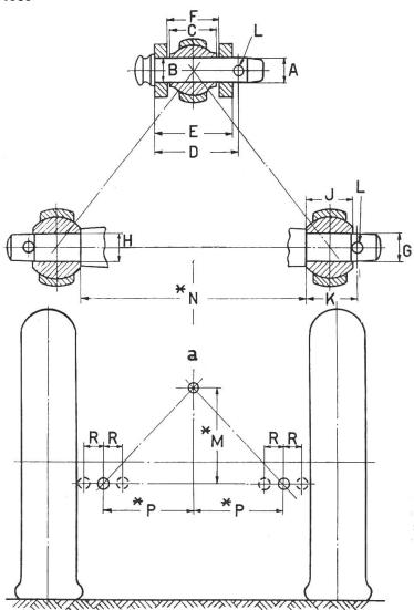
Abb. 7: Abmessungen der Kupplungspunkte bei Dreipunkt-Anbau der Kategorie 1 und 2.
