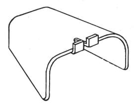
Abb. 5: Zapfwellenschutz nach VSM-Norm 28451.
