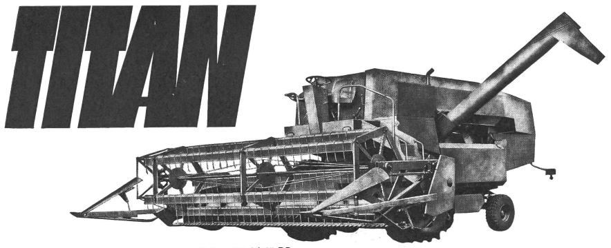
Schnittbreiten: 5,40 m - 4,50 m - 3,60 m. Motor: 6 Zyl./125 PS
