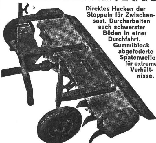
Direktes Hacken der Stopeln für Zwischen-saat. Durcharbeiten auch schwerster Böden in einer Durchfahrt. Gummiblock abgefederete Spatenwelle für extreme Verhält-nisse.
