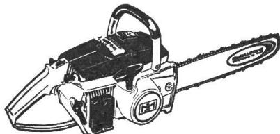
McCulloch hat seine Motorkettensägen mit elektrischem Anlasser versehen — d. h. ihnen ist es als ersten gelungen, einen kleinen Benzinmotor für Handstart durch ein eingebautes Starter- und Batteriesystem elektrisch in Gang zu setzen. 10 speziell dafür entwickelte langlebige Nickel-Cadmium-Batterien, die sich während dem Betrieb der Säge selbst aufladen, sind raumsparend im Haltegriff eingebaut. Ein Spannungsregler sorgt hier vor dem Ueberladen.
