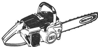
Mc Culloch hat seine Motorkettensägen mit elektrischem Anlasser versehen — d. h. ihnen ist es als ersten gelungen, einen kleinen Benzinmotor für Handstart durch ein eingebautes Starter- und Batteriesystem elektrisch in Gang zu setzen. 10 speziell dafür entwickelte langlebige Nickel-Cadmium-Batterien, die sich während dem Betrieb der Säge selbst aufladen, sind raumsparend im Haltegriff eingebaut. Ein Spannungsregler sorgt hier vor dem Ueberladen.
