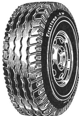
**Ackerwagen-Reifen:** Die breitausladende Lauffläche des Firestone-Ackerwagenreifens verhindert das Einsinken im Gelände bei geringstem Rollwiderstand. Er ist für höchste Belastung konstruiert. Seine zickzack-förmigen tiefen Längsrillen geben ihm Spurtreue. Massive Greifklötze in der Schulterzone erleichtern das Herausfahren aus tiefen Fahrspuren und verbessern das Bremsvermögen.
