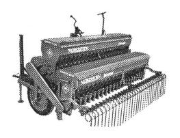
Nordsten, die dänische Sämaschine stammt aus einer Fabrik, die bereits 1877 gegründet wurde. Diese Maschine hat entscheidende Vorteile, wie z. B. der automatische Spuranzeigerwechsler, automatischer Scharsenk- und Hebemechanismus, automatische Getriebeausschaltung beim Heben der Maschine usw. Die Scharen der Nordsten-Maschine können sich nie mit Erde verstopfen. Sie ist vollständig wartungsfrei, lediglich die Laufräder müssen geschmiert werden. Die Sämaschine ist für
