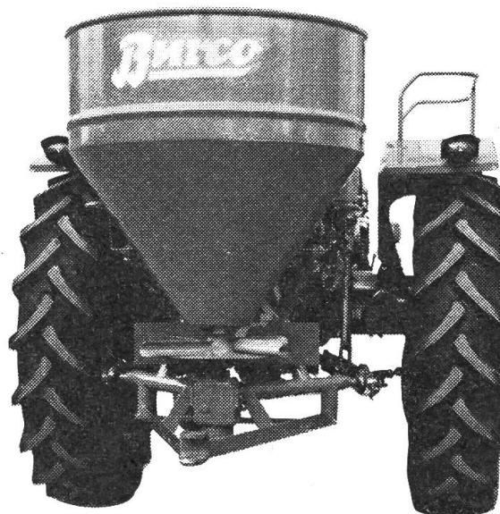
Der **Anbau-Düngerstreuer** Burco zeichnet sich besonders durch seine solide und robuste Konstruktion aus. Das Getriebe ist aus gehärtetem Spezialstahl, kugelgelagert in Oelbad laufend und abgedichtet; daher wenig Verschleissmöglichkeit und keine Verschmutzung. Nur eine einzige Schmierstelle ist am Rührwerk. Einfacher Anbau an die Dreipunkt-Aufhängung.
