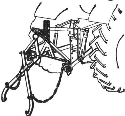
zum Schleifen von Stämmen bis 60 cm Ø, ohne Seilwinde oder Ketten. Einfache Montage (siehe Abbildung) an der Hydraulik. Das Schleifen der Stämme mit der neuen Stammzange schont Jungwuchs und Waldwege, da der Stamm an einem Ende abgehoben wird. Das Abheben des Stammes erfolgt wie z. B. das Heben eines Pfluges mit der Hydraulik. Verwendung für jeden Traktor.
