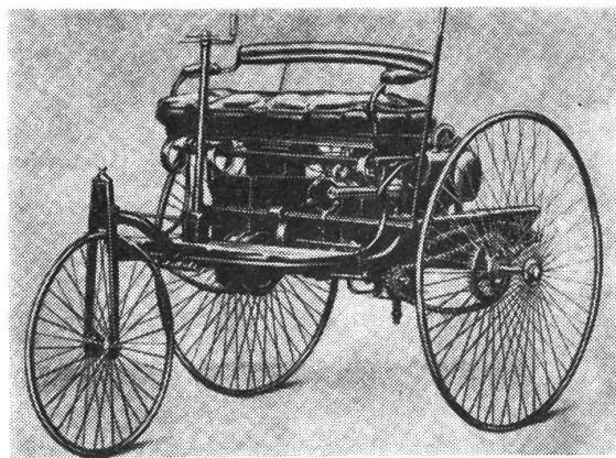
Dieses Dreirad mit Heckmotor war ums Jahr 1886 das erste tatsächlich funktionierende und käufliche Automobil mit Explosionsmotor. Es ist sozusagen das Modell Nummer 1 der heutigen modernen Automobilindustrie.
