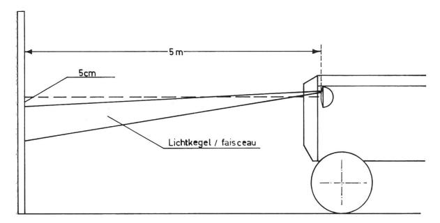
Man stellt den waagrecht stehenden Traktor in einem Abstand von 5 m vor eine senkrechte Wand. Die Scheinwerfer stehen richtig, wenn bei Abblendlicht der obere Rand des Lichtkegels mindestens 5 cm unter der Waagrechten liegt. Dabei ist zu berücksichtigen, dass eine starke Belastung der Hinterachse (Anbaugeräte an der Dreipunkt-Hydraulik) zu einer Entlastung der Vorderräder und damit auch zu einer Höherstellung des Abblendlichtes führt.
