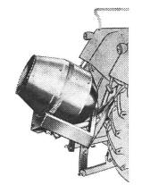
mit Dreipunkt-Hydraulik. Antrieb durch Zapfenwelle. Mischtrommel mit 125 Liter Nutzleistung. Ohne Antriebswelle **Fr. 470.—**.
