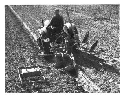
Kombikrümler in Verbindung mit Winkeldrehpflug im Einsatz.
