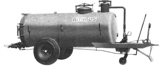
serienmässig: — neuer Kombi-Verteiler — neues Rührwerk im Fass auf Wunsch: — 2. Ansaugstutzen — Spezialgelenkwelle für enge Kurven
