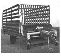
Durch das Schneidwerk zum Beispiel: Die Messer vom Agrar-Schneidwerk sind 44 cm lang und stehen durch den Rundlauf des Elevators immer im Einsatz. Dadurch wird die ungeahnte Laufruhe des Agrar-Ladewagens erreicht und der erstaunlich geringe Bedarf an Antriebskraft.
