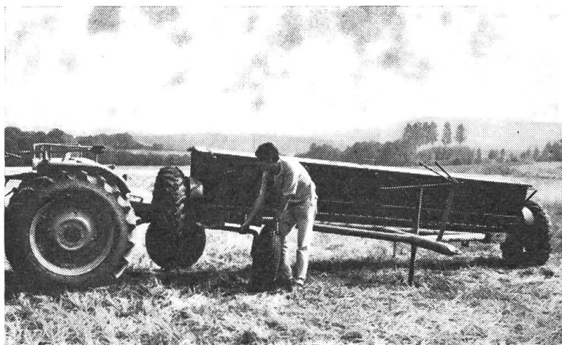
Abb. 1: Die für den Strassenverkehr zu breite Maschine wird mit der Traktorhydraulik angehoben. Nun können die beiden Halbachsen in eine passende Halterung gesteckt werden.
