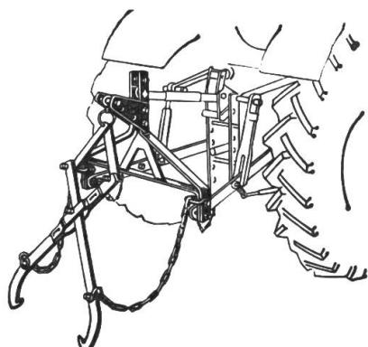
zum Schleifen von Stämmen bis 60 cm Ø, ohne Seilwinde oder Ketten. Einfache Montage (siehe Abbildung) an der Hydraulik. Das Schleifen der Stämme mit der neuen Stammzange schont Jungwuchs und Waldwege, da der Stamm an einem Ende abgehoben wird. Das Abheben des Stammes erfolgt wie z. B. das Heben eines Pfluges mit der Hydraulik. Verwendung für jeden Traktor
