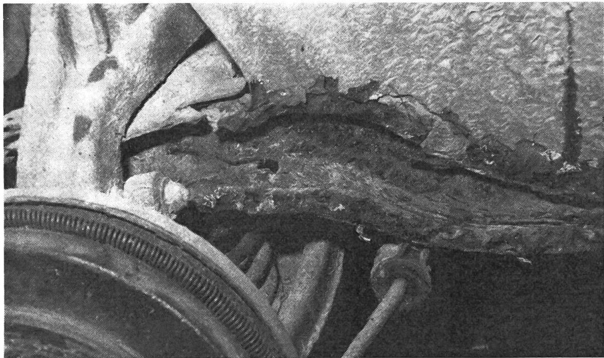
Chassis und Traversen sind gänzlich durchgerostet, eine Reparatur lohnt sich hier nicht mehr. Der Käufer liess sich durch die auf Hochglanz polierte Karosserie irreführen, erst Servicearbeiten in der Garage brachten den Schwindel an den Tag.
