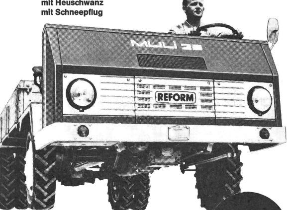
Starker luftgekühlter 2-Zylinder-Deutz-Dieselmotor von 25 DIN-PS, Allradantrieb, Differentialsperre, 8 Vorwärts-, 8 Rückwärtsgänge, hydraulische Vierradbremse, 1 Zapfwelle serienmäßig, weitere Zapfwellen auf Wunsch, Zwillingspneuräder hinten. Breite Spur, tiefe Schwerpunktlage, enorme Wendigkeit, Nutzlast bis zu 2100 kg.
