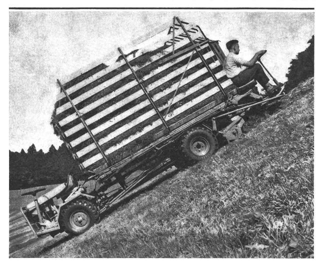
Schilter bringt ein neues Aufbau-Ladegerät mit Futteraufnahme vor den Vorderrädern! (Schweizer Patente angemeldet.) Der Kern der Idee: das neue Ladegerät hat hinten einen zweiten Führersitz! Aufgeladen wird im Rückwärtsgang! Dem Fachmann sind die daraus resultierenden vielen Vorteile sofort klar: bessere Übersicht, kein Überfahren des Futters mehr, geringe Kippgefahr, leichteres, schnelleres Arbeiten. Das neue Ladegerät bewältigt neben Heu und Emd auch zuverlässig das Ein-
